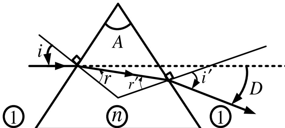
Soit  $r$  et  $r'$  les angles d'émergence et d'incidence respectivement sur les faces d'entrée et de sortie du prisme, et soit  $D$  l'angle de déviation entre rayon incident et rayon transmis.
