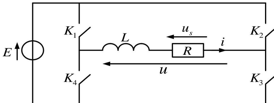
Les quatre interrupteurs bidirectionnels  $K_1$ ,  $K_2$ ,  $K_3$  et  $K_4$  sont commandés électriquement de telle façon que :
